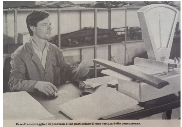
Fase di smontaggio e di pesatura di un particolare di una vettura della concorrenza.
